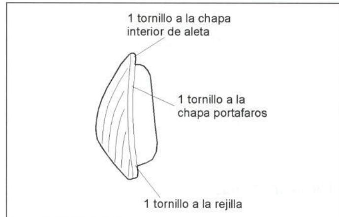
Figura 17.- Unión del faro delantero
