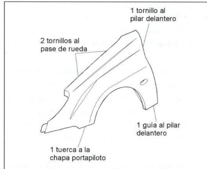
Figura 25.- Unión de la aleta delantera
