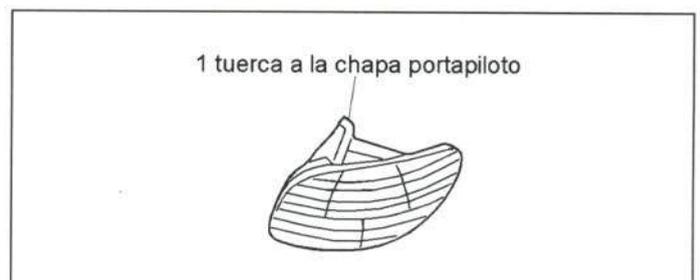
Figura 42.- Unión del piloto trasero
