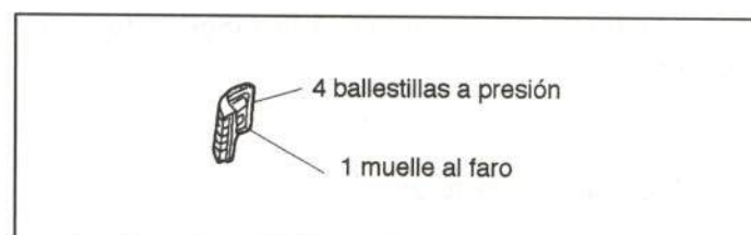
Figura 18.- Fijación del piloto delantero
