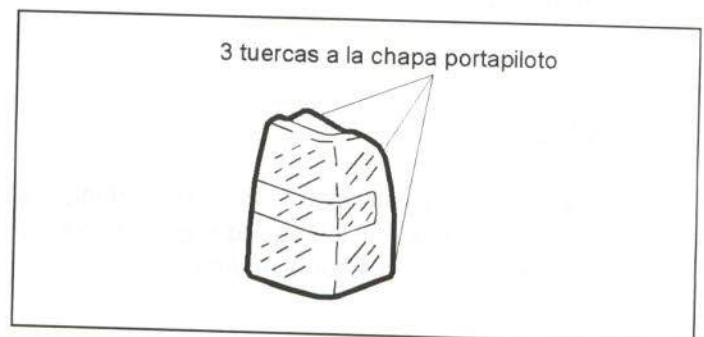
Figura 34.- Unión del piloto trasero
