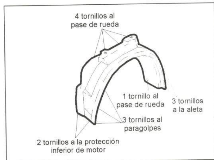
Figura 18.- Unión del guardabarros delantero
