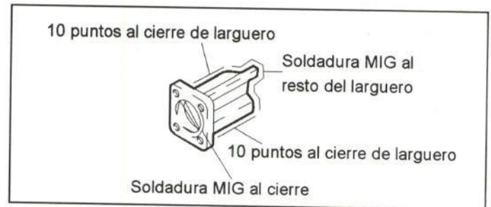
Figura 23.- Unión de la sección anterior del larguero delantero
