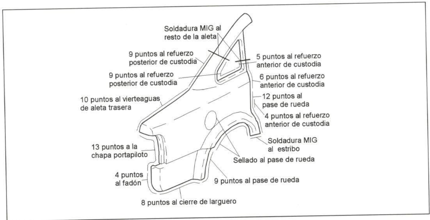
Figura 39.- Unión de la aleta trasera
