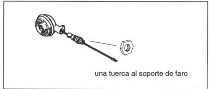
Figura 23.- Unión del intermitente delantero
