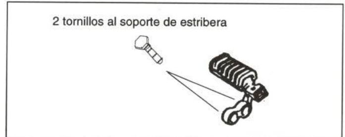
**Figura 29.-** Unión de la estribera delantera
