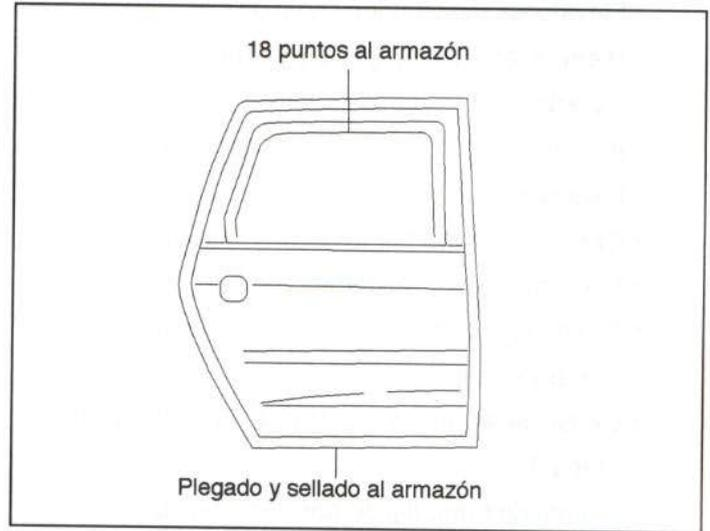
**Figura 33.- Unión del panel de puerta trasera**
