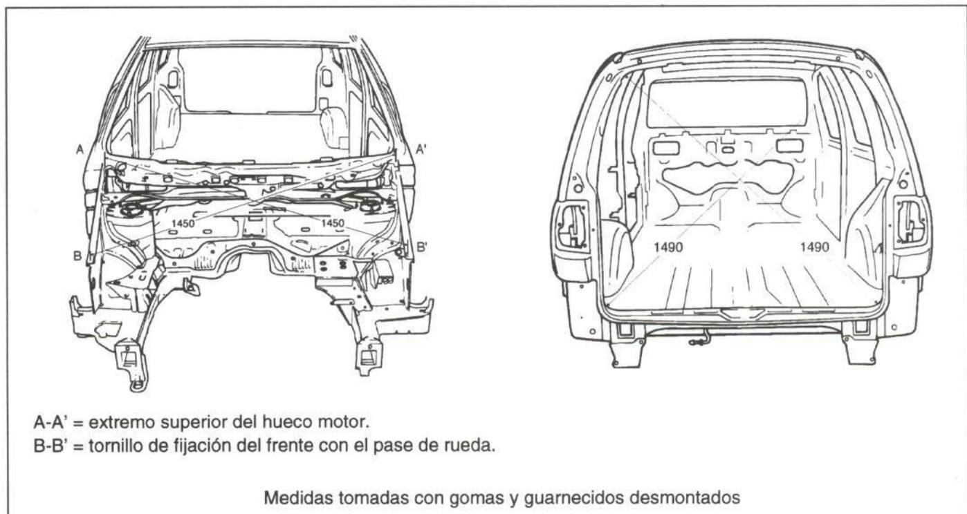
Figura 5.- Cotas de la parte delantera y trasera
