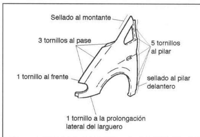
**Figura 21.-** Unión de la aleta delantera
