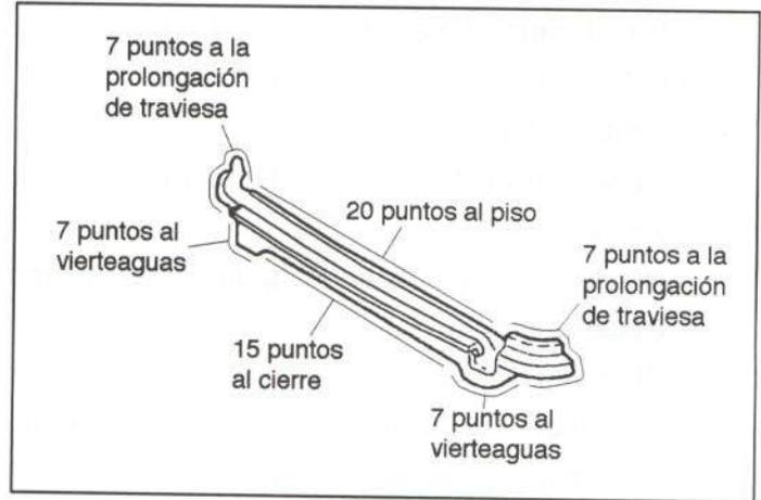
Figura 45.- Unión de la traviesa trasera
