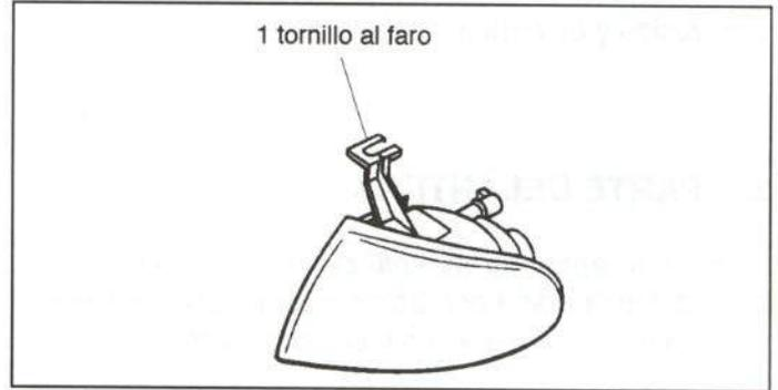
Figura 13.- Unión del piloto delantero
