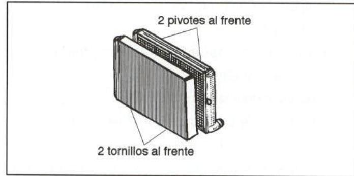
Figura 50.- Unión del radiador
