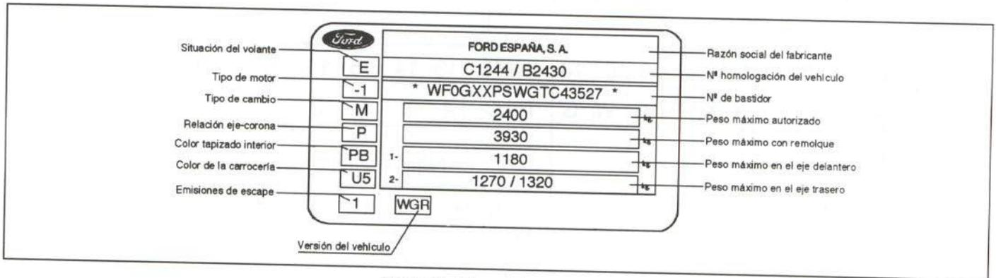
Figura 2.- Placa del constructor
