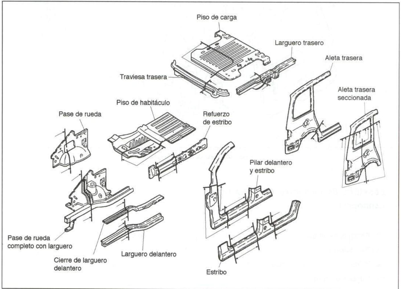
Figura 11.- Sustituciones parciales contempladas por el fabricante
