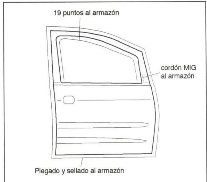
Figura 30.- Unión del panel de puerta delantera
