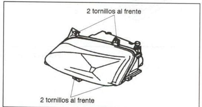
Figura 15.- Unión del faro
