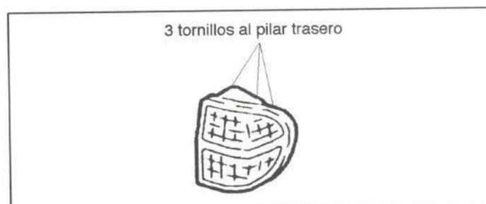
Figura 38.- Unión del piloto trasero
