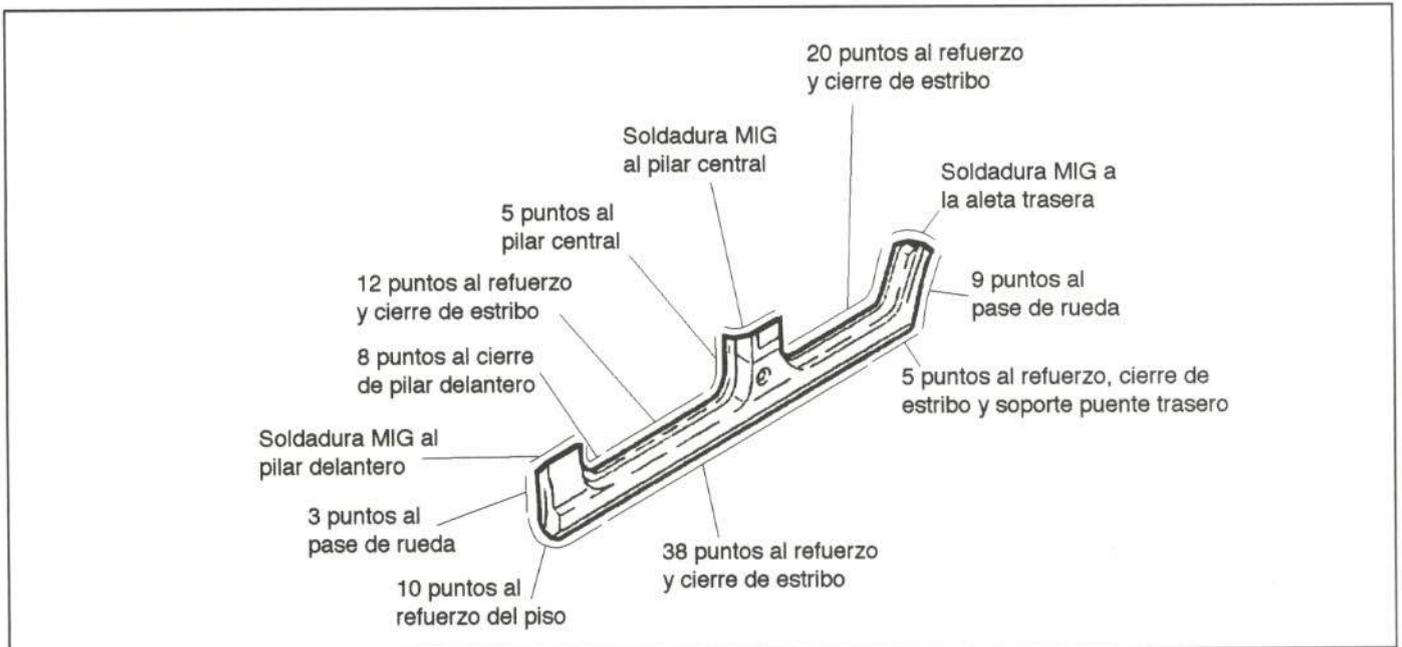
Figura 35.- Unión del estribo bajo puertas
