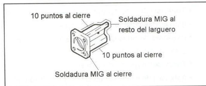
Figura 25.- Unión de la sección anterior del larguero delantero
