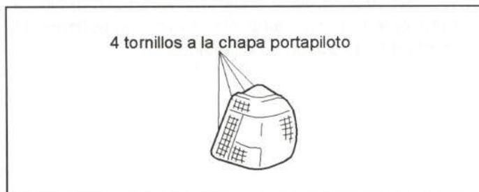
Figura 36.- Unión del piloto trasero
