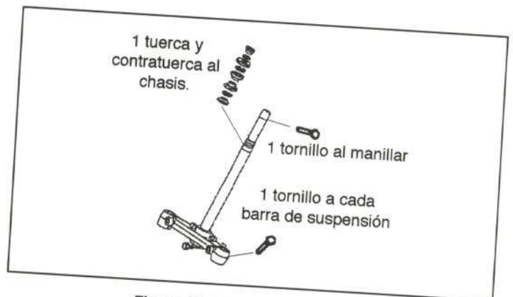
Figura 40.- Unión de la tija inferior
