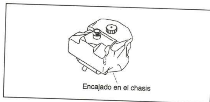
Figura 23.- Unión del depósito de combustible
