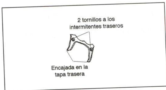
Figura 20.- Unión de la tapa de unión trasera
