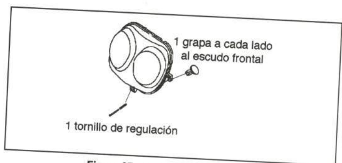
Figura 27.- Unión del faro delantero
