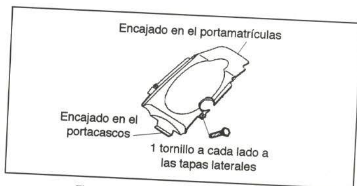
Figura 29.- Unión del guardabarros trasero
