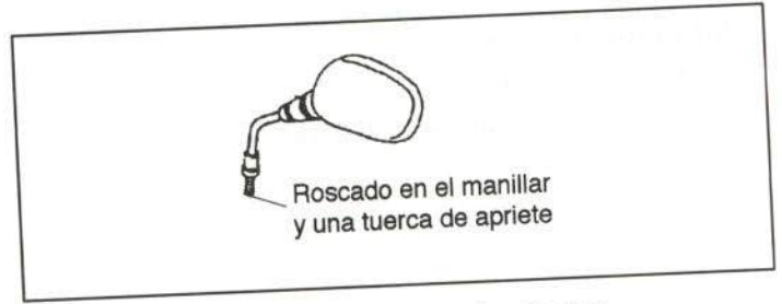
Figura 36.- Unión del espejo retrovisor
