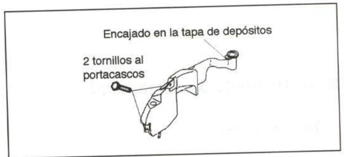
Figura 25.- Unión del depósito de aceite
