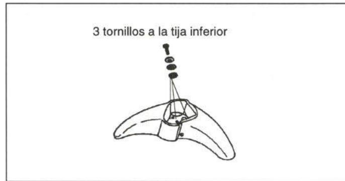
Figura 36.- Unión del guardabarros delantero
