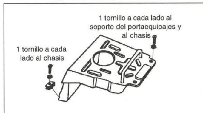
Figura 24.- Unión del protector del depósito de combustible
