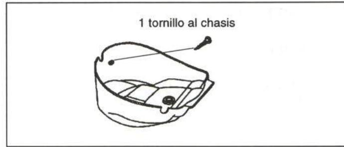
**Figura 25.-** Unión del portacascos
