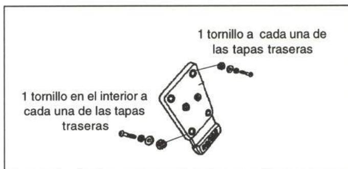
Figura 28.- Unión del portamatrículas
