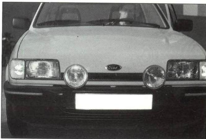
Figura 1.—Disposición de faros de largo alcance con alumbrado ordinario.
