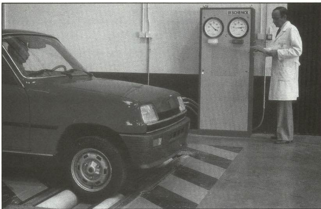
Figura 1.—Comprobación de frenos en Centro de Diagnóstico.
