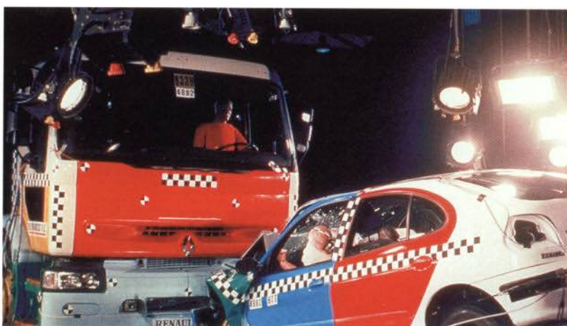
Disposición de los maniqués para el impacto frontal de las pruebas Euro NCAP
