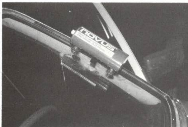
FIGURA 8 Endurecimiento de la resina con la lámpara de rayos ultravioletas
