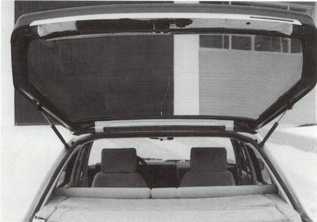
Cuando haya que sustituirlo, se desmontará previamente la cerradura y el cilindro de llave, los anagramas, los tacos de nivelación, el panel del revestimiento interior, el limpiacristal y su motor, la instalación eléctrica, los amortiguadores y la luneta térmica.
