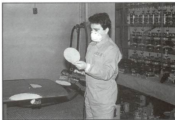
FIGURA 8.—Abrasivo con sistema de fijación adhesivo.
