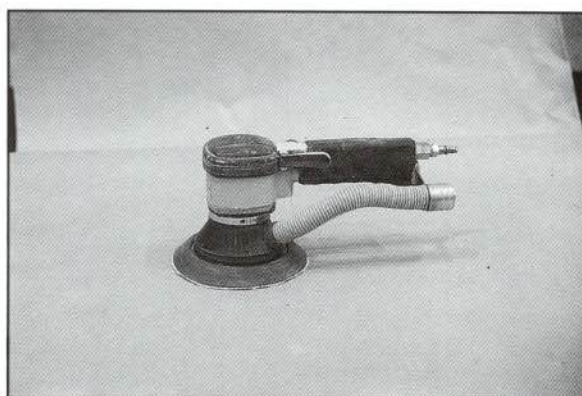
FIGURA 2.—Máquina excéntrico-rotativa neumática con sistema de extracción de polvo.
