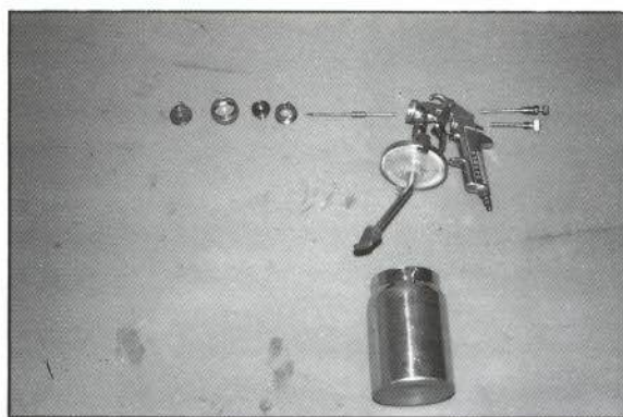
FIGURA 5.—Despiece de una pistola «de aspiración».
