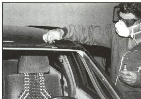
FIGURA 3.—Aplicación de imprimación sobre vidrio y sobre chapa.
