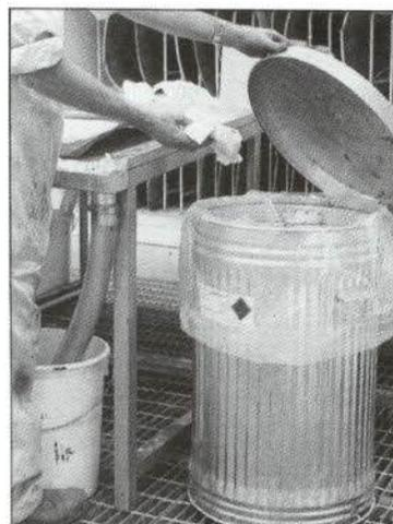
**FIGURA 2.**—Recipiente ignífugo provisto de cierre para residuos (papeles, trapos, etc.).
