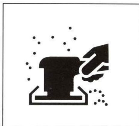
FIGURA 7.—Lijadora con aspiración de polvo.
