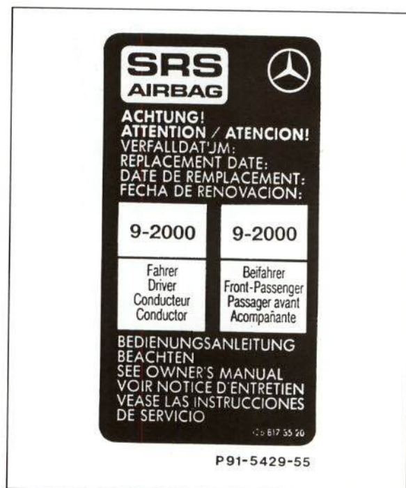
FIGURA. 2.- Placa de identificación de la fecha de caducidad
