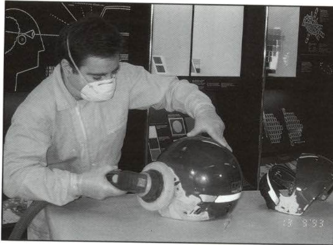
Figura 2. —Lijado de la zona reparada
