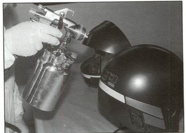
Figuras 5 y 6.—Pintado de adhesivos y barnizado final
