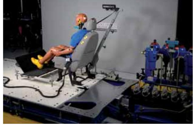
Prueba dinámica del ensayo de protección ante el latigazo cervical
