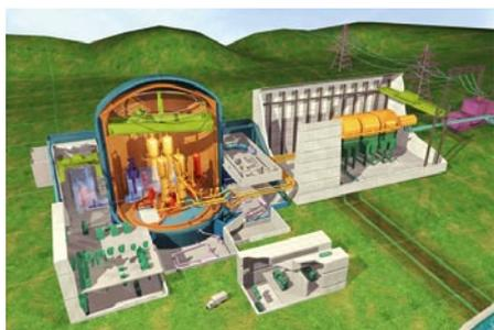
Esquema de un reactor EPR
