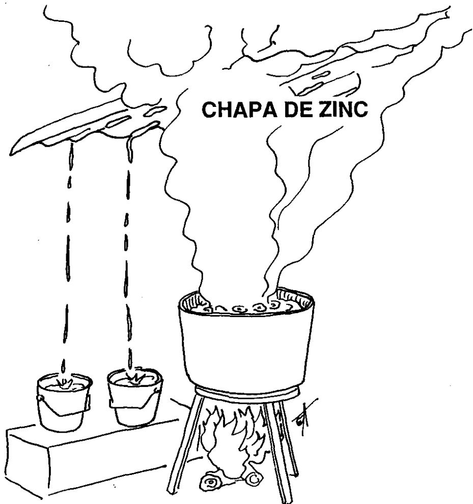
FIG. 32. ESQUEMA DE DESTILACION DE AGUA.
