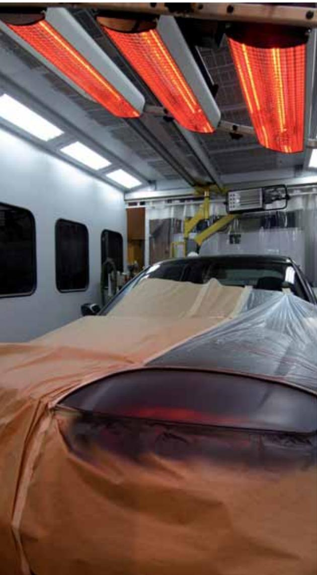
► Secado del aparejo mediante IR
