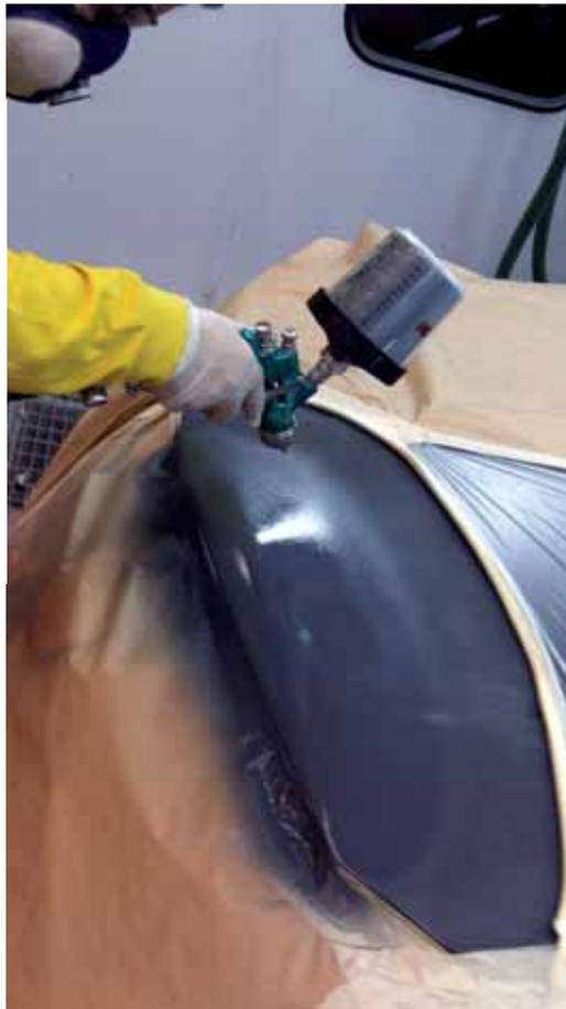
mezclaban con el color de la carrocería, llegando a tener una tonalidad parecida a la del color final. La mezcla del color acrílico 2K con el aparejo encarecía el producto final y mermaba las propias cualidades del aparejo; además, esta mezcla tenía un peor secado y endurecimiento, incrementando notablemente los tiempos y materiales en los procesos de lijado.
