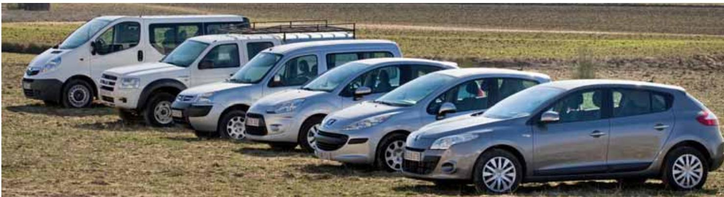
Las operaciones de mantenimiento asociadas a estos vehículos estarán condicionadas por su uso, y puede motivar una reducción de los intervalos genéricos de mantenimiento establecidos por el fabricante. Por ejemplo, la flota para la recogida de residuos tendrá fijado su intervalo de revisiones normalmente en función de las horas de funcionamiento de cada vehículo y no de los kilómetros recorridos.
