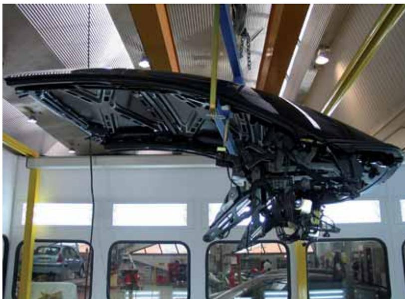
► Retirada del techo con útil específico
