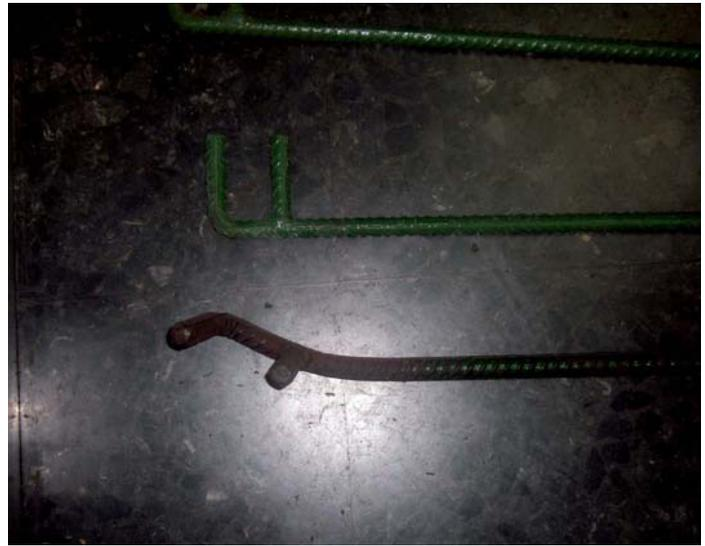
Fig. 2 Útil doblado por efecto de la fatiga.
