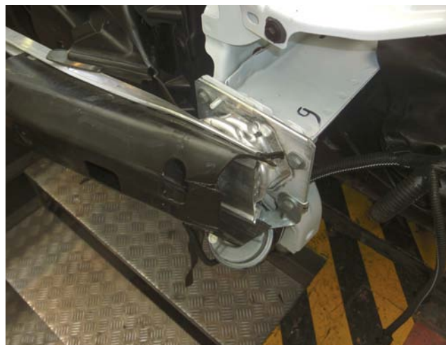
► Daños en la travesía delantera
