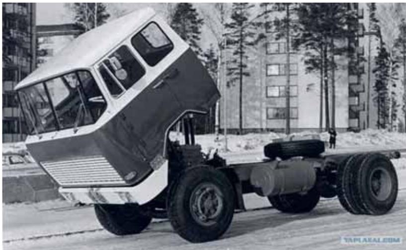
▶ Cabina con piso plano (sin túnel motor)
