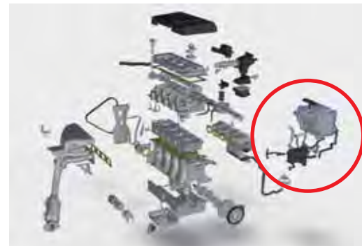
► Batería del sistema híbrido y sistema propulsor
