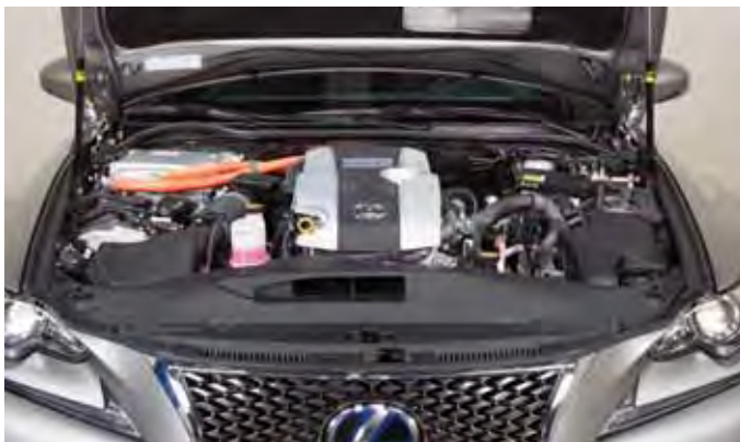
► Batería del sistema híbrido y sistema propulsor
