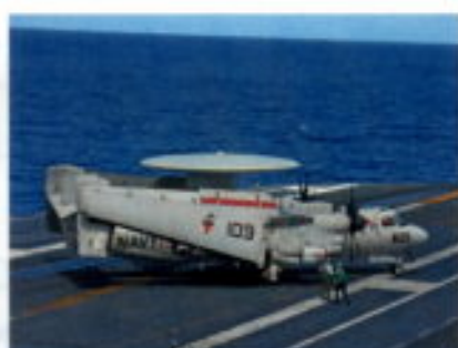
El E-2C Hawkeye, un avión táctico de alerta temprana. Tiene sensores que analizan las amenazas y controlan los objetivos, tanto de superficie como aéreos.
