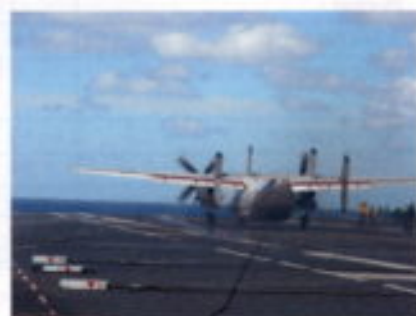
Un C-2A Greghomd se ha detenido después de haber cogido el cable de frenado. Estos aviones son el único medio de llegar por aire al portaaviones.
