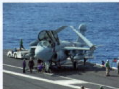
El EA-6B Prowler está especialmente diseñado para la guerra electrónica. Aquí lo vemos con las alas plegadas.
