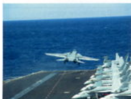
Un F-14 Tomcat despegando. Sobre una pista de sólo 90 m y en casi tres segundos, la catapulta lo pone a 160 km/h.
