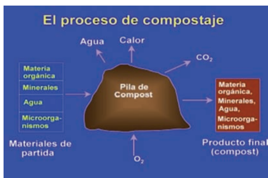
Figura 1. Esquema del proceso de compostaje y pila de compostaje a escala real.
