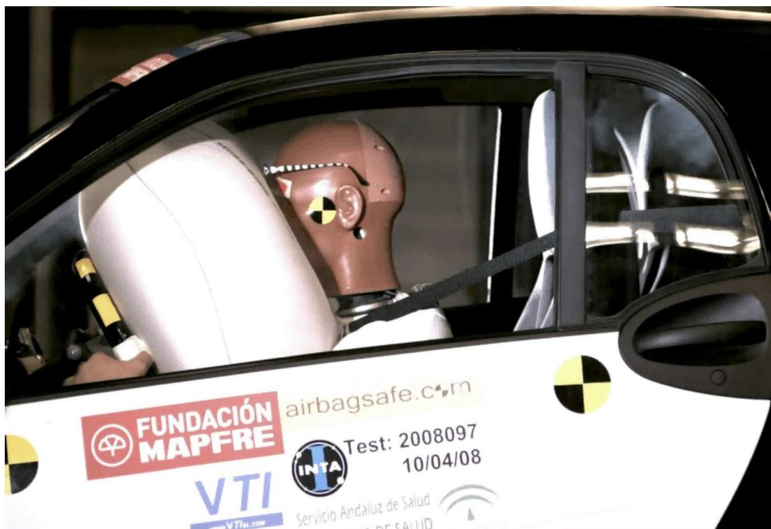
El choque 3 a baja velocidad de 25 km/h es nuevamente supraumbral para el decelerómetro, produciéndose el despliegue del airbag. Una montura rígida con una óptica de policarbonato quedan atrapadas entre la cara del dummy y la bolsa del airbag. Los resultados son análogos en valores a los del ensayo anterior.
