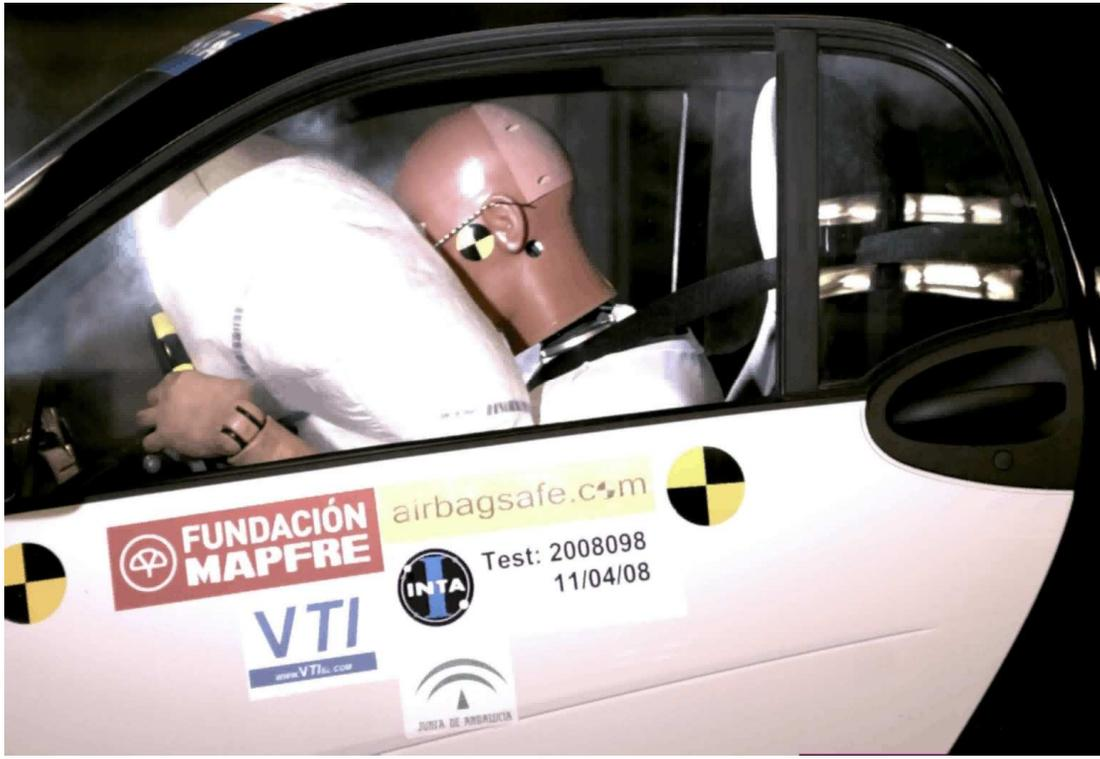
El ensayo 4 repite las condiciones del ensayo 3 en cuanto a la velocidad de colisión de 25 km/h pero en este caso con unas gafas de montura al aire con cristal de policarbonato. La transmisión de la energía de la resultante del impacto al globo ocular es superior a la de los casos anteriores.
