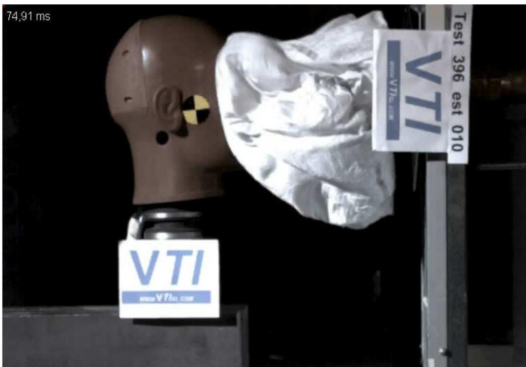
Imagen del estudio 10 del estallido del airbag en banco de pruebas sobre la cabeza Denton Focus sin gafas para servir de referencia comparativa.
