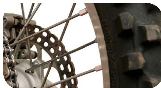
La adherencia es la capacidad del neumático para mantener en todas las condiciones de uso al límite del vehículo (frenada, aceleración y curva) un buen coeficiente de adherencia con el pavimento. Esta característica resulta determinante para la seguridad en la marcha, sobre todo en firmes mojados. En caso de condiciones extraordinarias causadas por lluvias intensas o en caso de desgaste avanzado de los neumáticos puede llegarse a la pérdida total de adherencia.
