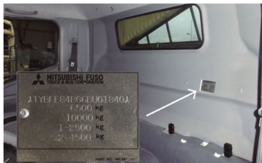
▶ Placa de fabricante Mitsubishi Fuso en pared trasera
