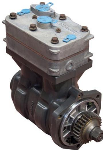
► Compresor del sistema neumático
