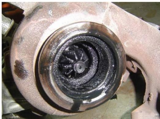
► Turbocompresor averiado
