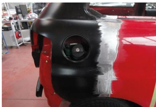
► Repaso de los puntos de soldadura
