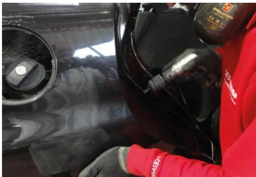
► Eliminación de puntos con lijadora de banda
