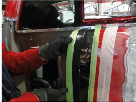
► Resultado final después del desbarbado de los puntos de soldadura
