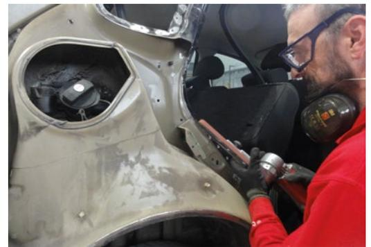
► Eliminación de puntos con despunteadora regulable
