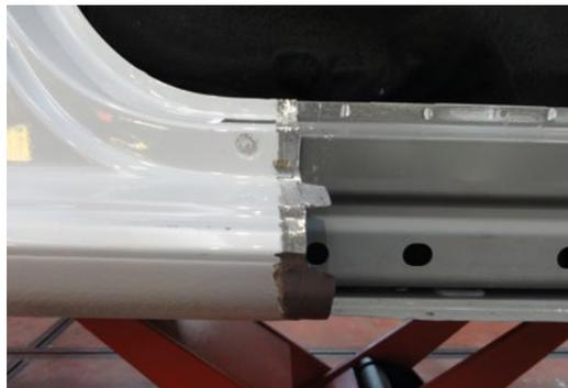
► Resultado final después del desbarbado de los puntos de soldadura
