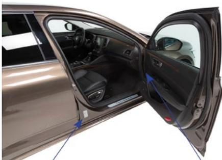
**Placa del fabricante:** Adhesivo pegado en el pilar B derecho
