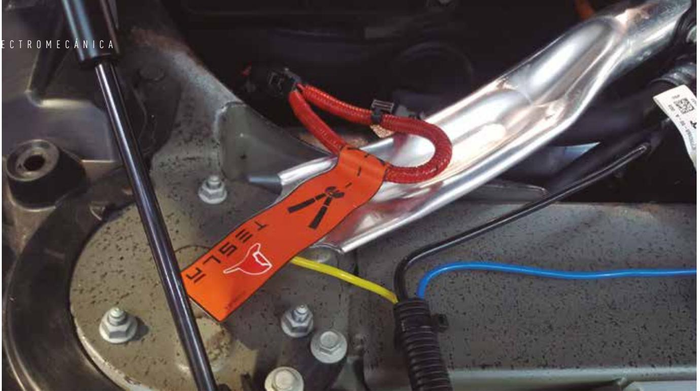
► Cable de corte para desconexión rápida en caso de rescate
