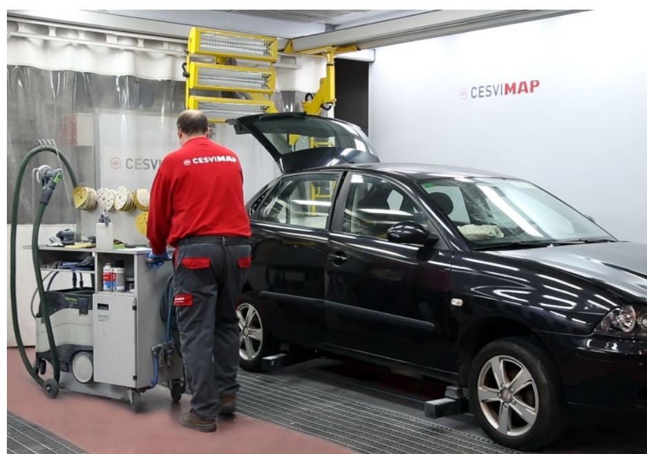
► Preparación de materiales, herramientas y equipos, previa al pintado
