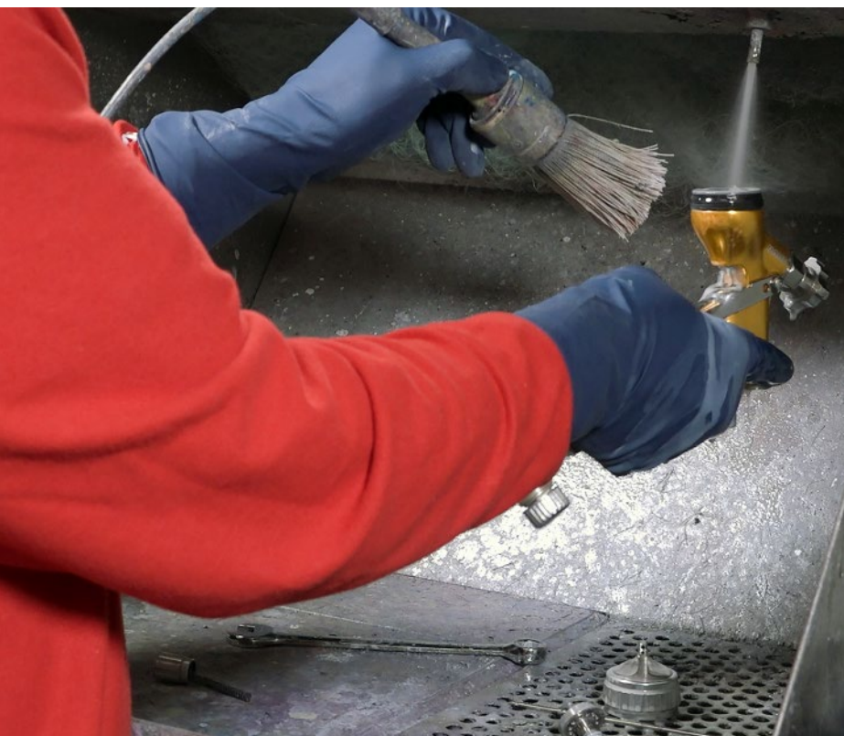
► Limpieza de la pistola con disolvente apropiado
