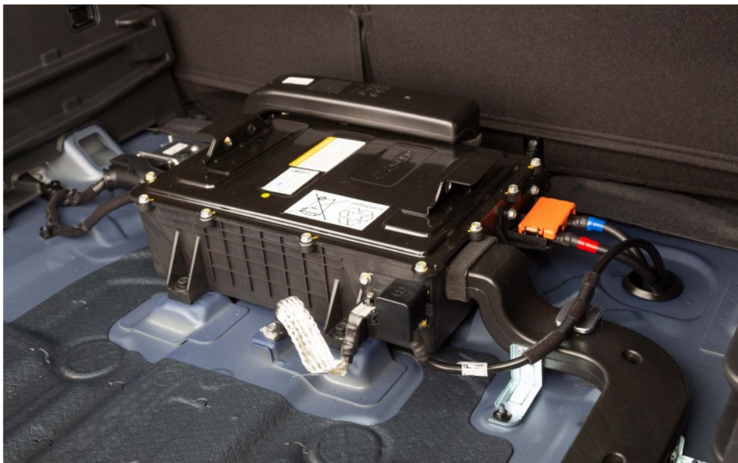
► Batería de 48 V de polímero de litio del Hyundai Tucson, ubicada en el maletero
