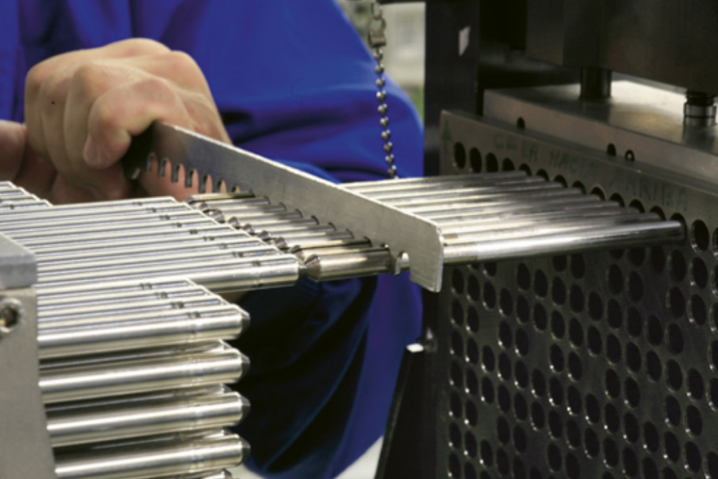
Fabricación de varillas de combustible en la fábrica de Juzbado (Salamanca)
