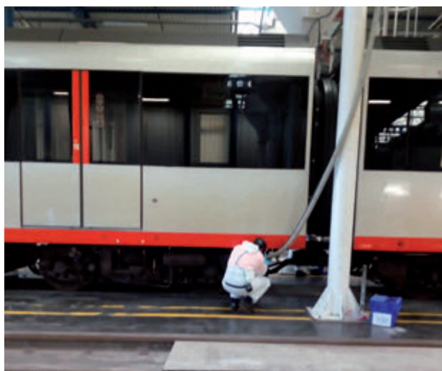
■ Figura 3 ■ (a) Tolvas equipadas con dispositivos de carga y (b) Operación de carga de arena de una UT de Metro Bilbao
