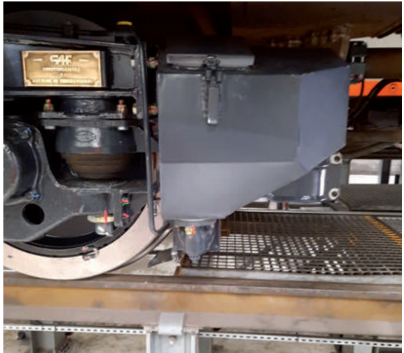
■ Figura 1 ■ Depósito de sílice cristalina de una UT de Metro Bilbao, donde se observa la boquilla para verter la arena de sílice a la vía
