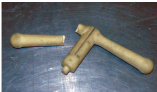
Fig. 4. Prototipo A fracturado.
