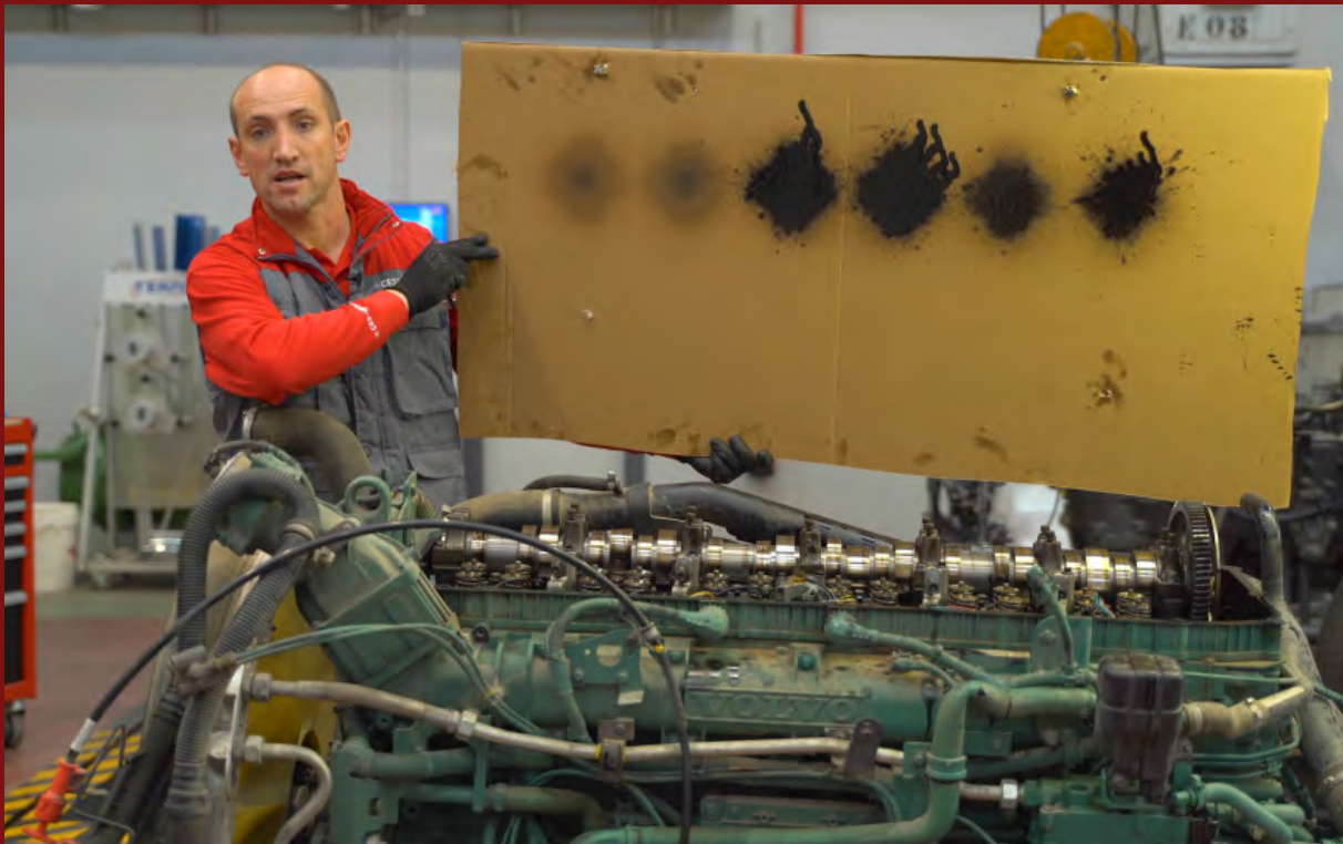
Comprobación del aceite alojado en el interior de los pistones
