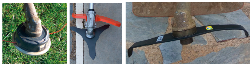
■ Figura 2 ■ Motodesbrozadora: ejemplos de útiles de corte; disco de hilo, tres puntas y triturado
