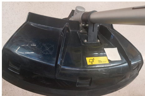
■ Figura 3 ■ Motodesbrozadora: ejemplos de protecciones
