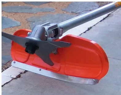
■ Figura 3 ■ Motodesbrozadora: ejemplos de protecciones
