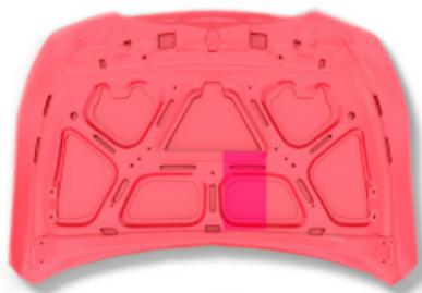
**3 Sistema de capó activo:** Este sistema de seguridad pasiva tiene como objetivo reducir la gravedad de las lesiones del peatón si es atropellado.
