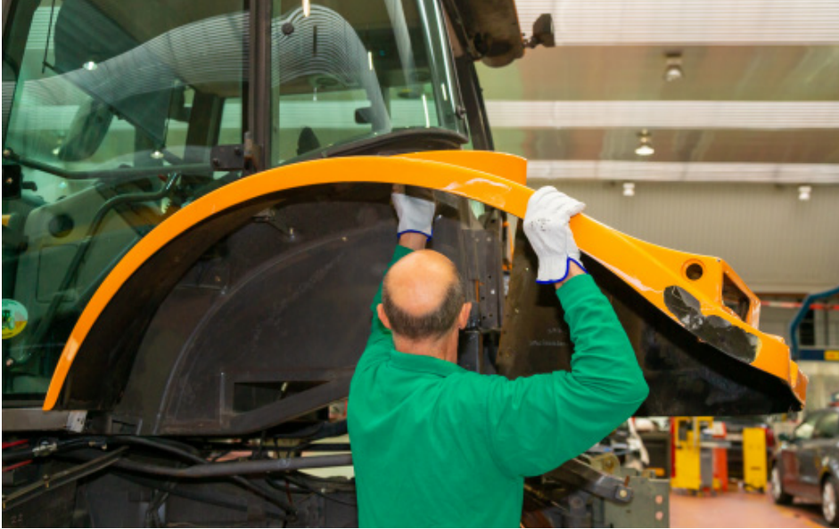
Reparación del guardabarros de un tractor
