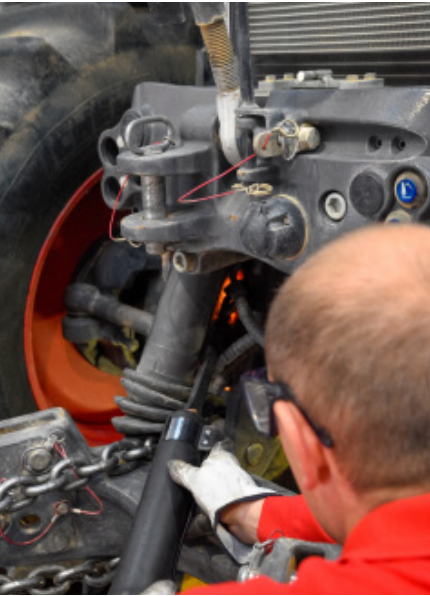
Reparación del chasis de un tractor utilizando calor por inducción
