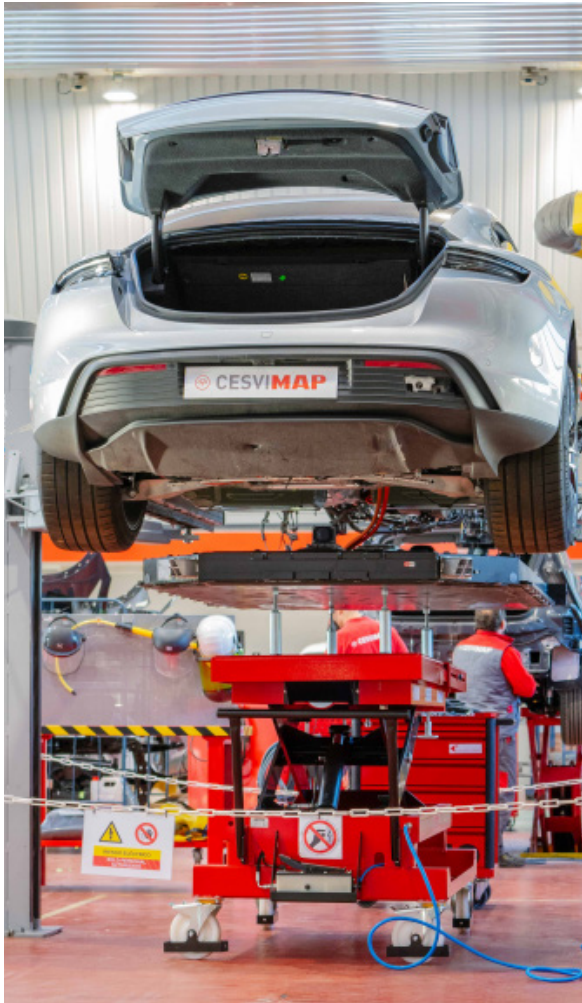
Proceso de desmontaje de una batería de alta tensión con mesa elevadora ASTRA
