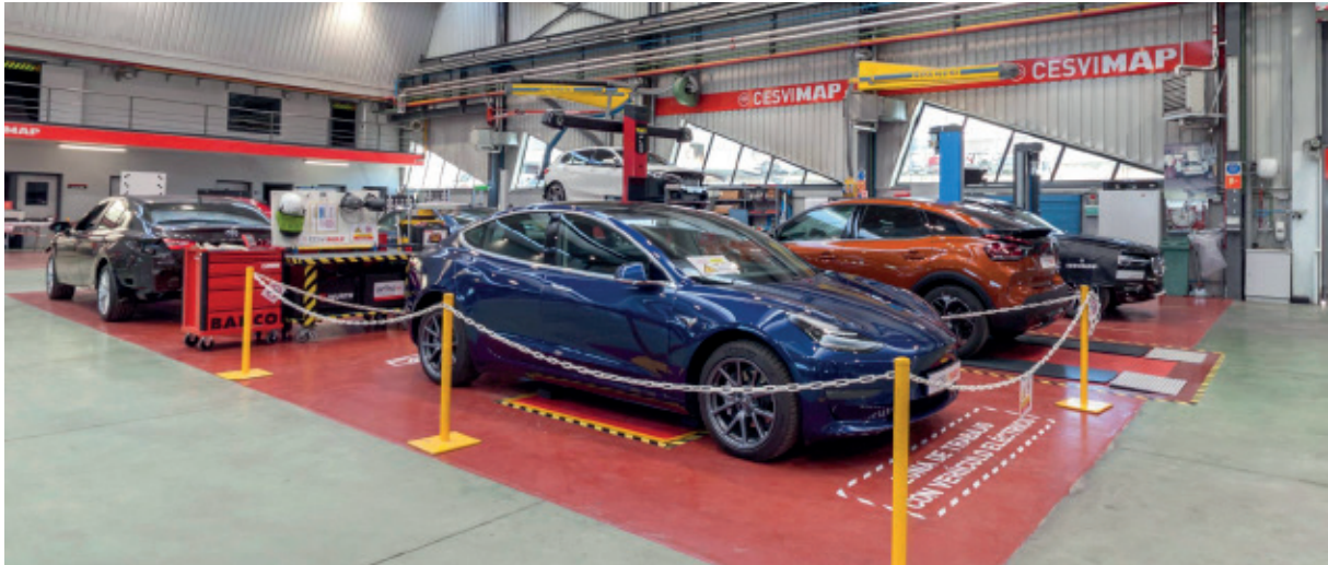
Delimitación y señalización de la zona de trabajo con vehículo eléctrico.
