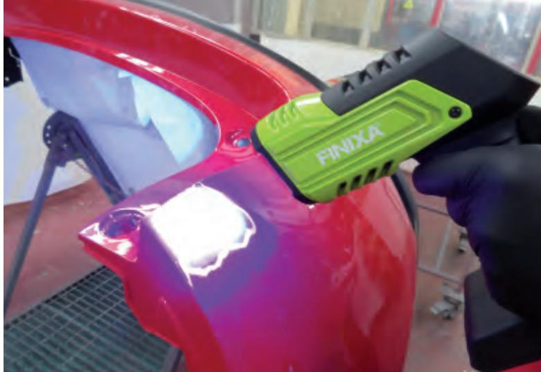
Secado y curado por radiación ultravioleta
