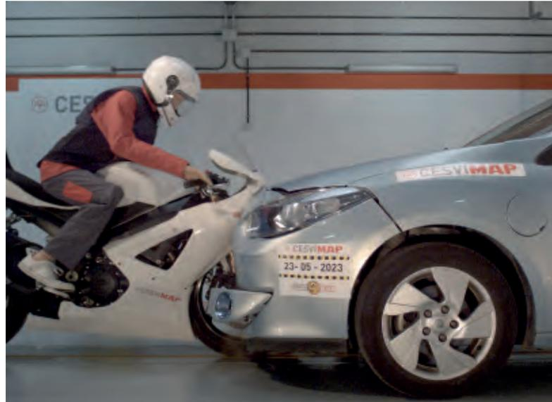
Ensayo a 40 km/h del airbag electrónico
