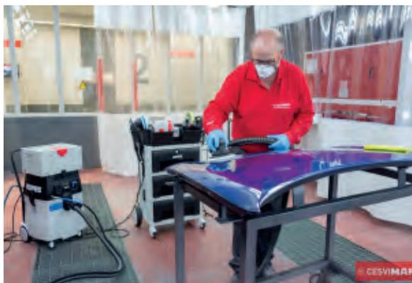
Proceso de lijado eficiente
