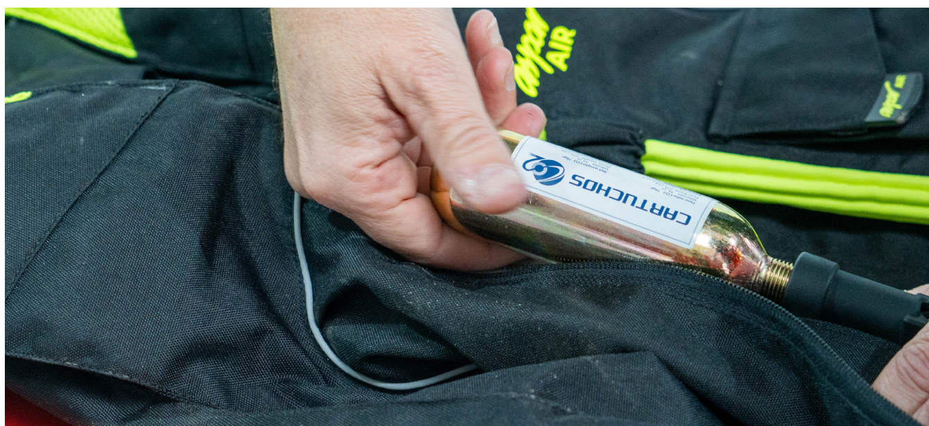
Figura 11. Sustitución de la botella que contiene el gas a presión
