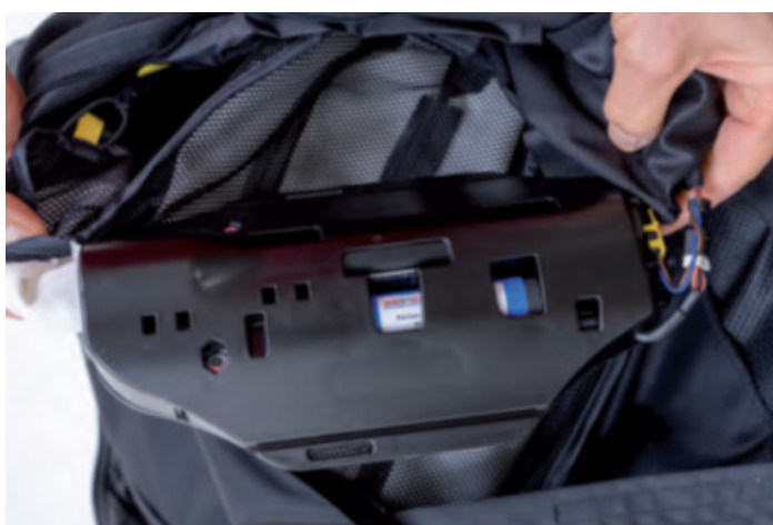
Figura 6. Unidad de mando y sensorización de un airbag de moto electrónico
