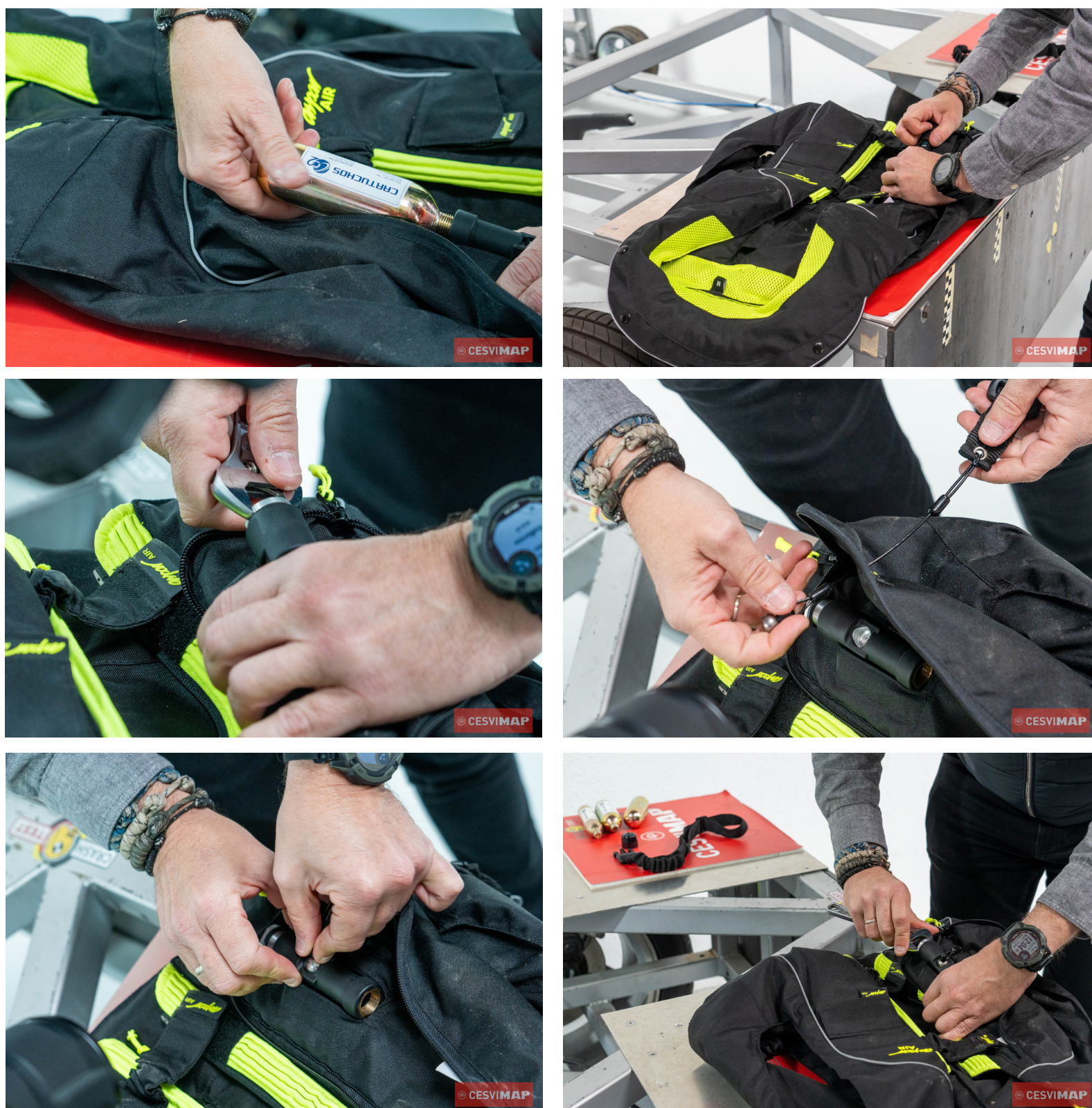
Figura 25. Secuencia de pasos para la sustitución de la botella que contiene el gas a presión
